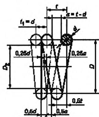
Рисунок В.1 — Крайний виток пружины сжатия без оттяжки концов с поджатием на  $\frac{3}{4}$  дуги окружности
